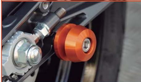
スライダー本体は強度に優れたジュラルミン製。不意に起こった衝撃を滑らせて分散し、フロントフォークボトムケース及びスイングアームへのダメージを軽減します。また、本体は6mmの溝幅を持つスタンドフック構造になっており、レーシングスタンドを掛ける事によって車体のメンテナンスを容易に行えるようになっております。カラーはKTMのイメージカラーのオレンジ。デザインではKTMならではの特徴的なシャープでソリッド感を演出しております。
